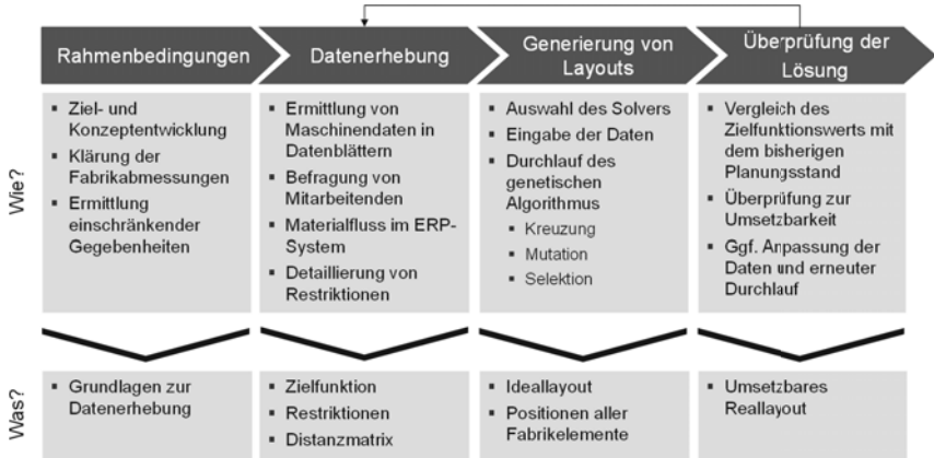
Abbildung 2.8: Vorgehen zur algorithmenbasierten Layoutplanung, eigene Darstellung in Anlehnung an [Kr21a]
