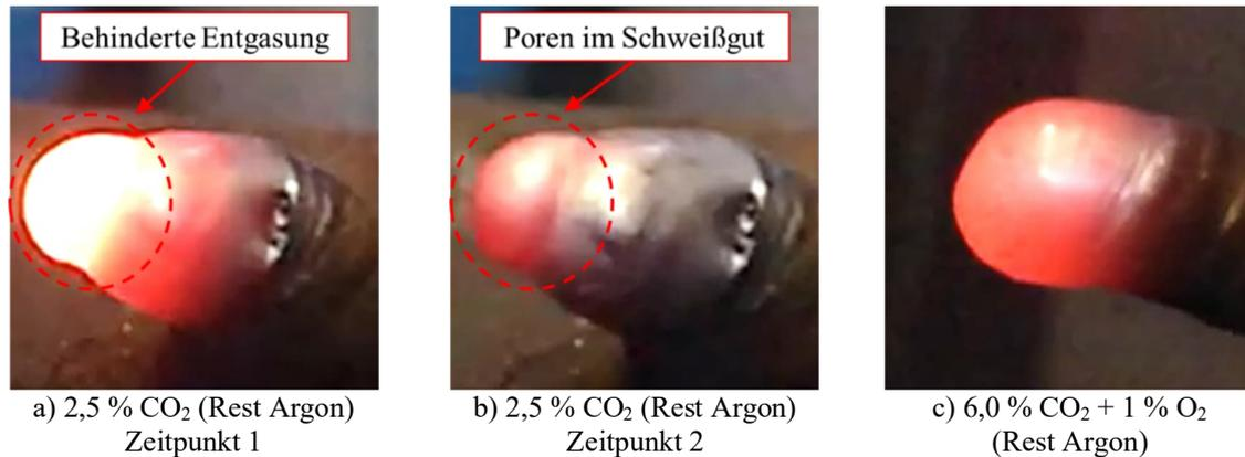
Bild 4.6 Fotos des erhärtenden Schweißtropfens bei einer punktuellen Schweißung mit verschiedenen Schutzgasen
