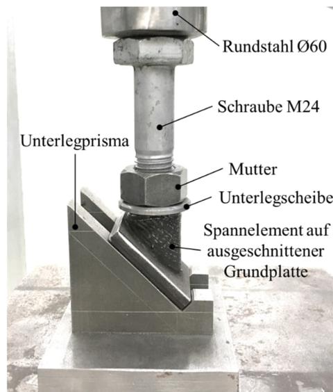
Bild 7.14 Versuchskörper Spannelement M24 im Versuchsaufbau, Versuchsreihe 3
