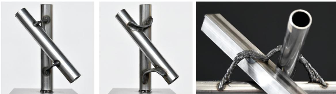
Bild 3.17 Varianten zur Verbindung von Rohren<sup>3</sup>Bild 3.18 Weiterentwicklung der Hohlprofilverbindung<sup>4</sup>
