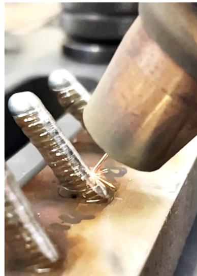
b) Berührung der unter Spannung stehenden Drahtelektrode mit dem Werkstück
