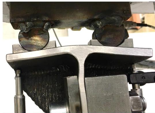
Bild 8.12 Versuchskörper TS-1,3 – 1 bei Versuchsabbruch (Weg = 21,3 mm, Kraft 590 kN)
