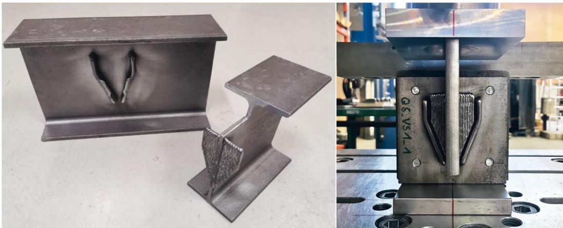
Bild 3.22 WAAM-Querkraftanschluss<sup>2</sup>
