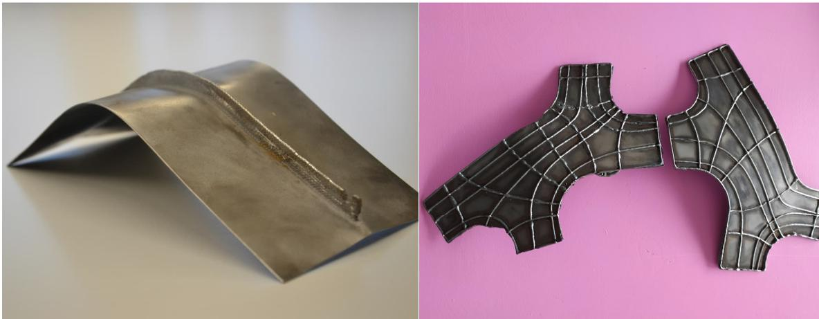
Bild 3.13 Mittels WAAM verstärkte und ausgesteifte Dünobleche (Fotos: Christopher Borg Costanzi)
