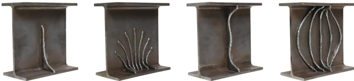
Bild 3.21 Demonstratoren zur Beul-Aussteifung eines IPE 200
