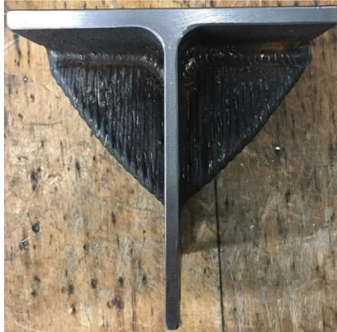
Bild 7.9 Versuchskörper Teilsteife, Versuchsreihe 3
