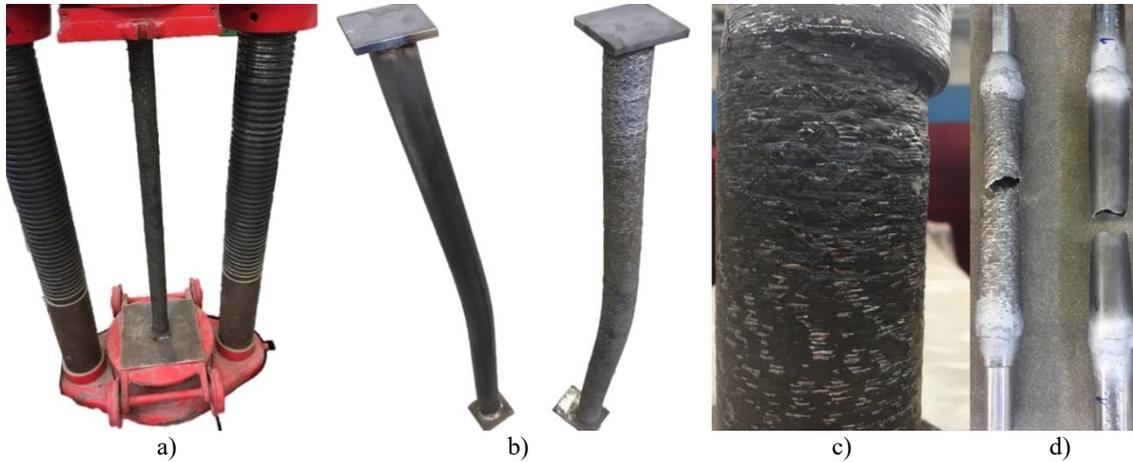
Bild 3.19 Rohrstütze a) in der Prüfmaschine b) gewalzt und additiv gefertigt c) Verformungen aufgrund von Imperfektionen nach dem Druckversuch d) Zugproben (links additiv gefertigt, rechts gewalzt)
