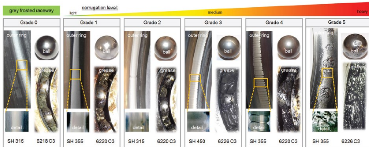
Abbildung 2-6: Unterschiedliche Stadien der elektrischen Lagerschädigung. Quelle: Tischmacher (2018) S.20; © 2018 IEEE.
