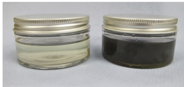
Abbildung 2-5: Schmierstoff vor (links) und nach (rechts) elektrischen Durchschlägen. Quelle: Schneider et al. (2022a) S.4. © 2022 MDPI
