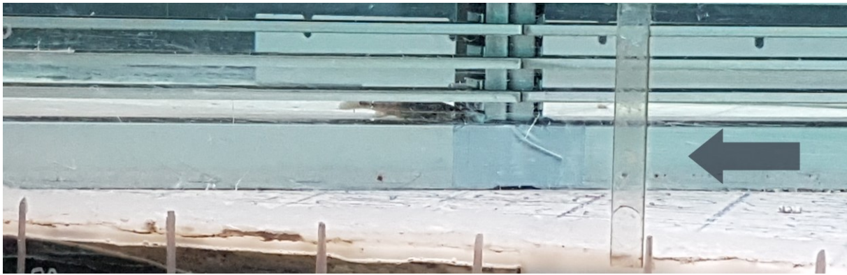
Abbildung 5.24: Entraining eines Rückkehrer-Gründlings seitlich und leicht stromab hinter einer Stütze
