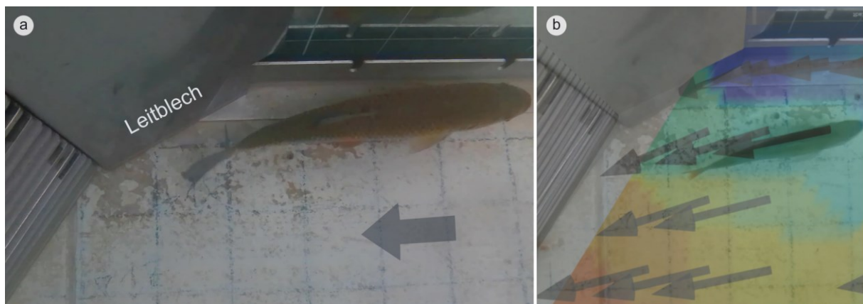
Abbildung 5.25: Wandhalten (und Bow-riding) vor dem Leitblech: (a) Döbel; (b) Flussbarsch mit überlagerten Geschwindigkeitsvektoren und Konturdarstellung (ADV-Messdaten); Blautöne stehen für niedrige und Rottöne für hohe Geschwindigkeiten, sodass ein Gradient in Richtung des ersten Rechenfeldes zu erkennen ist.
