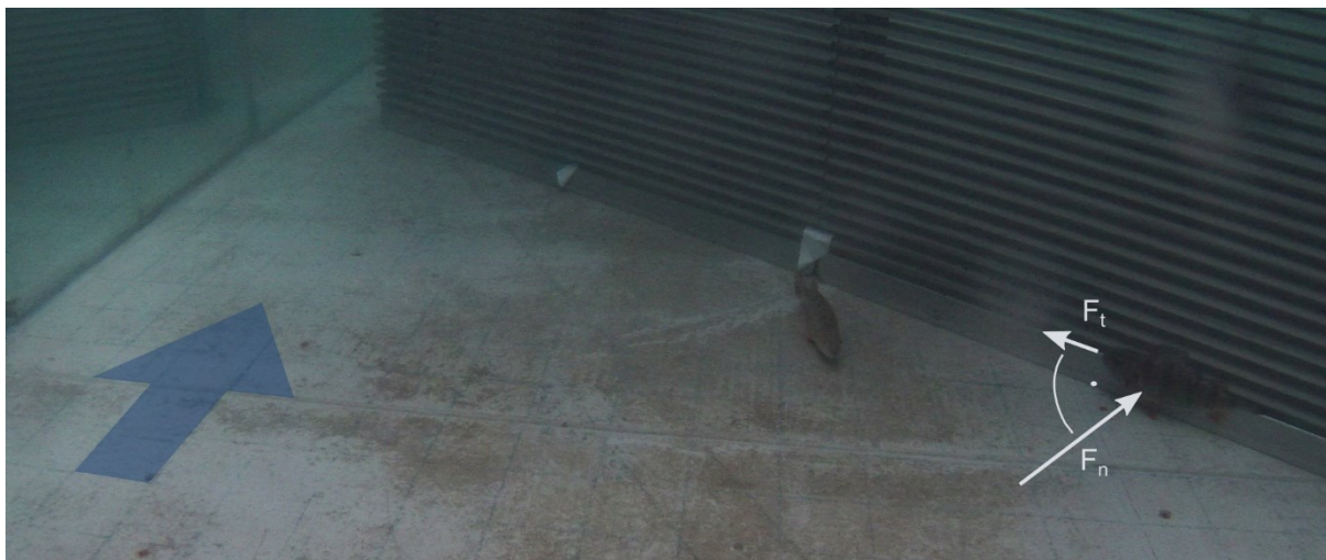
Abbildung 5.21: Ethohydraulische Tests mit Flussbarschen am 55° Rechen: Impingement eines Flussbarsches, der sich nicht mehr selbstständig vom Rechen lösen konnte; die senkrecht zum Rechen bzw. dem Fischkörper wirkende Anpresskraft F_n ist so groß, dass die zum Rechen tangential, auf den Fischkörper wirkende Kraft F_t aufgrund der kleinen Angriffsfläche nicht ausreicht, um den Fisch in Richtung Bypass zu verschieben.
