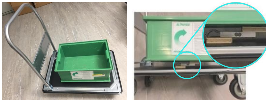
Abbildung 44: „Intelligente Palette“ (links) und Gewichtssensor im Detail (rechts) 631
