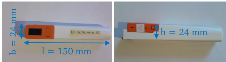
Abbildung 59: Sensoren „Intelligenter Materialfluss“ – Neigungssensor mit integriertem Mikrocontroller 660
