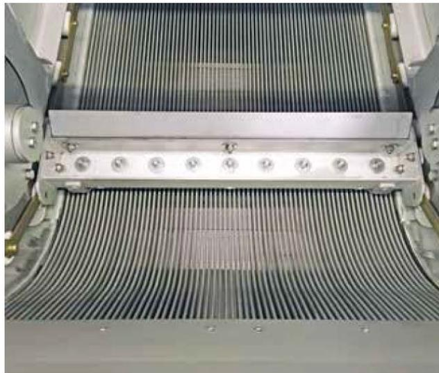
Abbildung 2.11: Umlaufende Abräumvorrichtung eines Hakenumlaufrechens der Fa. Huber (Foto: [www.huber.de](http://www.huber.de)).
