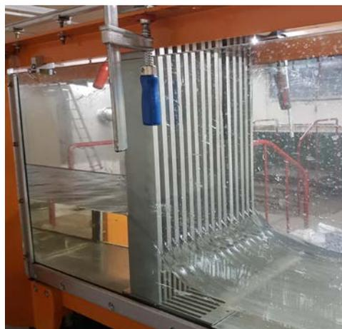
Abbildung 3.26: Flachstab F1070 Rechen mit 10 mm Stababstand bei einem Aufstellwinkel  $\alpha_R$  von 90°-
