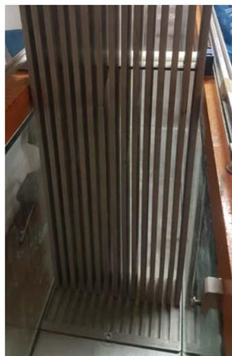
Abbildung 3.5: Rechen Flachstab 10 mm x 70 mm, Stababstand 10 mm, Aufstellwinkel 90° im Laborgerinne
