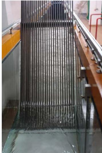
Abbildung 3.27: Rechen mit Flachstab F1070, Stababstand  $b_R = 10$  mm und Aufstellwinkel  $\alpha_R = 60^\circ$ .
