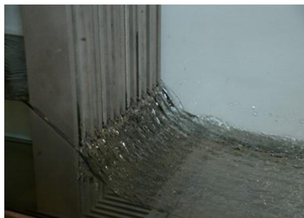
Abbildung 5.12: Foto des Laborgerinnes mit Rechen F1070 bei einem Stababstand von  $b_R = 10\text{ mm}$ , einem 30 mm hohem Wehr und einem Volumenstrom von  $Q = 20\text{ l/s}$ .
