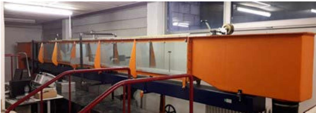
Abbildung 3.1: Foto des Laborgerinnes S6 Tilting Flume der Firma Armfield an der htw saar.
