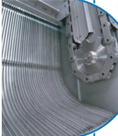
Abbildung 2.10: Gebogene Rechenstabgeometrie im Sohlbereich eines Hakenumlaufrechens der Firma Kuhn (links), Fotos: [www.kuhn-gmbh.de](http://www.kuhn-gmbh.de)
