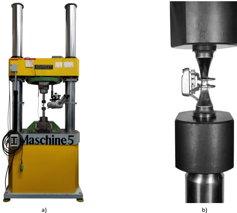
Abbildung 3.4: a) Servohydraulischer Prüfstand, b) Detailansicht einer eingebauten Werkstoffprobe.
