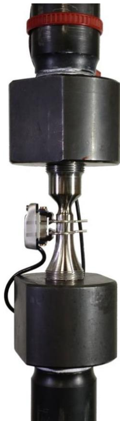
Abbildung 3.11: Detailansicht einer eingebauten Kerbprobe.
