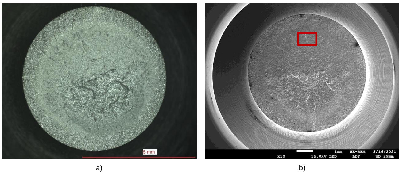
Abbildung 3.25: Exemplarische Darstellung einer typischen Bruchfläche beim einsatzgehärteten 16MnCr5 mit Bruchausgang im Probeninneren ( S_a = 511,34 MPa, N_A = 379809 ): a) Lichtmikroskopische Aufnahme, b) REM-Aufnahme.
