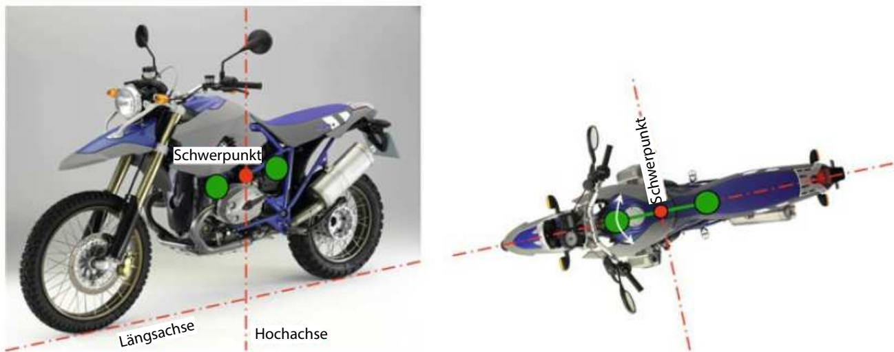
Abbildung 2-4: Schwerpunkt und Längsachse (in diesem Fall identisch mit der Reifenaufstandslinie) eines Einspurfahrzeugs; beispielhaft an einem Motorrad 9
