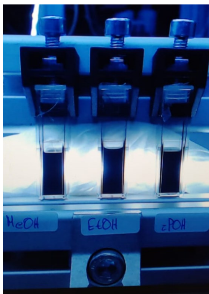
Abbildung 48: Fotodokumentation a) Fotoaufnahmestation und b) Stabilitätstest der Standard- Tintenzusammensetzung mit fünf verschiedenen Lösungsmitteln H 2 O, MeOH, EtOH und 1-,2-Propanol und einem IC-Verhältnis von 0,54 und einem Verhältnis von Wasser zu Alkohol von 0,04.
