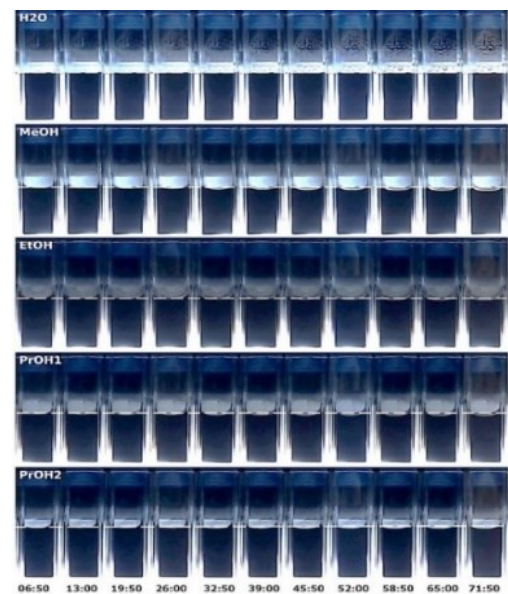
Abbildung 48: Fotodokumentation a) Fotoaufnahmestation und b) Stabilitätstest der Standard- Tintenzusammensetzung mit fünf verschiedenen Lösungsmitteln H 2 O, MeOH, EtOH und 1-,2-Propanol und einem IC-Verhältnis von 0,54 und einem Verhältnis von Wasser zu Alkohol von 0,04.
