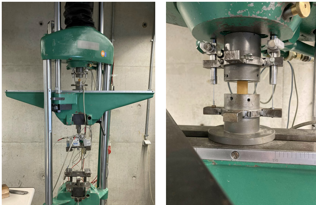
Abbildung 3.5: Versuchsaufbau der Druckversuche in der Übersicht (l.) und im Detail (r.)
