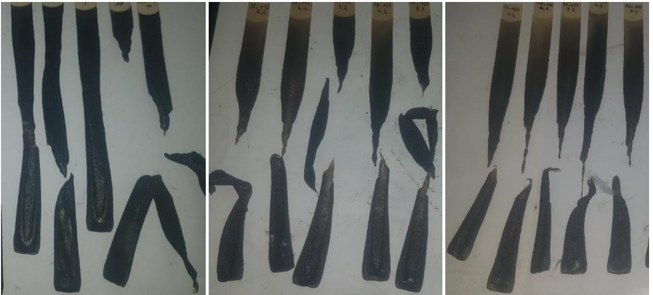
Abbildung 8: Photographien gebrannter UL-94 V-Prüfkörper (0,8 mm) mit einem Gesamtgehalt von 20 wt%. Von links nach rechts: Zn-DOPOx:MPP = 1:1 (PA_68); Zn-DOPOx:MPP:DEPAL = 1:2:1 (PA_152) und Zn-DOPOx:MPP:DEPZn = 1:2:1 (PA_154).
