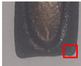
Abbildung 30: Schematische Darstellung des mittels REM-EDX untersuchten Bereichs am Beispiel eines gebrannten UL 94 V-Prüfkörpers von PA_Zn-DOPOx:MPP (1:1).
