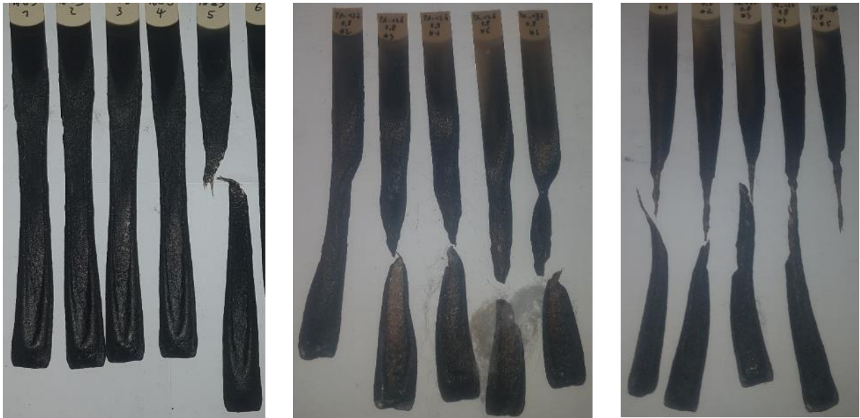
Abbildung 7: Fotografien gebrannter UL-94 V-Prüfkörper (0,8 mm) mit einem Gesamtgehalt von 21,9 wt%. Von links nach rechts: Zn-DOPOx:MPP = 1:1 (PA_89); Zn-DOPOx:MPP:DEPAL = 1:2:1 (PA_136) und Zn-DOPOx:MPP:DEPZn = 1:2:1 (PA_137).
