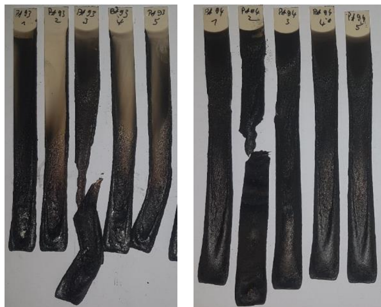
Abbildung 6: Photographien gebrannter UL-94 V Prüfkörper (0,8 mm) mit den Verhältnissen: Zn-DOPOx:MPP = 1:2 (links; PA_93) und Zn-DOPOx:MPP = 2:1 (rechts; PA_94).
