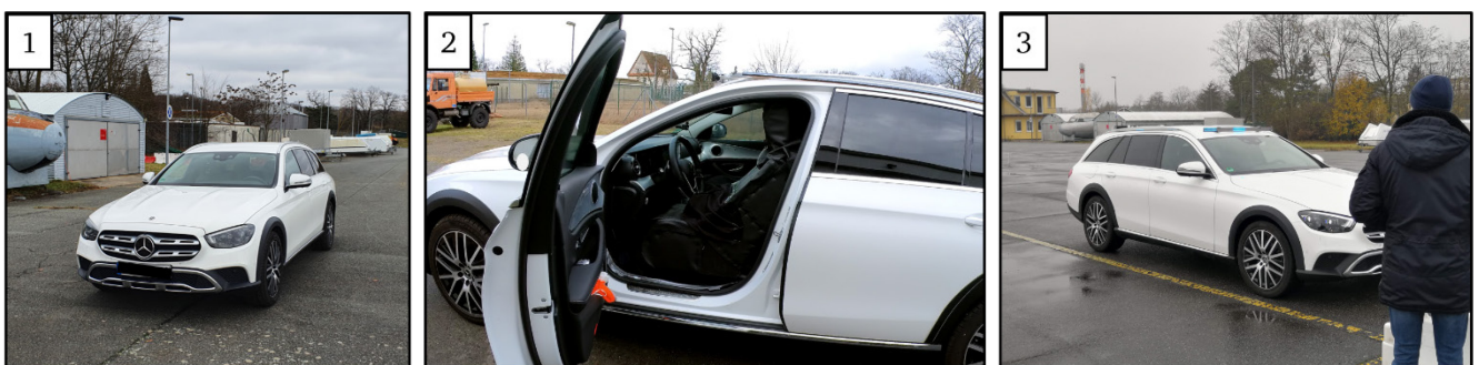
Abbildung 5-1: Wizard-of-Oz Pkw. (1) Mercedes-Benz E220d 4Matic T-Modell All-Terrain in polarweiß (Länge: 4947 mm, Breite: 1861 mm, Höhe: 1497 mm). (2) Ghost-Driver-Sitzkostüm. (3) Wizard-of-Oz Fahrzeug mit eMMS vor einer Versuchsperson
