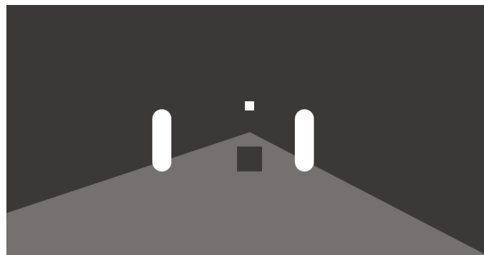
Abbildung 3.10.: Versuchsaufbau der Detektionsstudie mit geteiltem Adaptationsfeld nach DAMASKY [56]; der dargestellte Beobachtungsschirm simuliert den nächtlichen Verkehrsraum aus Sicht eines Fahrzeugführers, die quadratischen und stabförmigen Objekte stehen vereinfacht für relevante Objekte im Straßenverkehr wie Verkehrszeichen oder Fußgänger.
