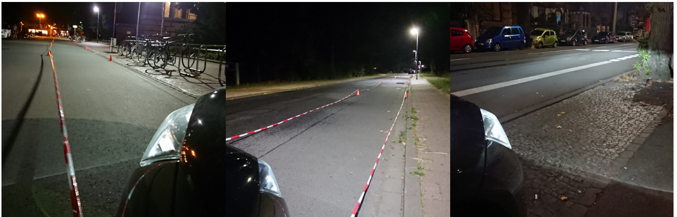
Abbildung 4.10.: Teststraßen für die Studie zur Helligkeitswahrnehmung innerhalb geschlossener Ortschaften; die Teststraßen weisen verschiedene Fahrbahnleuchtdichteniveaus auf, Teststraße 1 (links, Verkehrsstraße), Teststraße 2 (mitte, Anliegerstraße), Teststraße 3 (rechts, Hauptverkehrsstraße).
