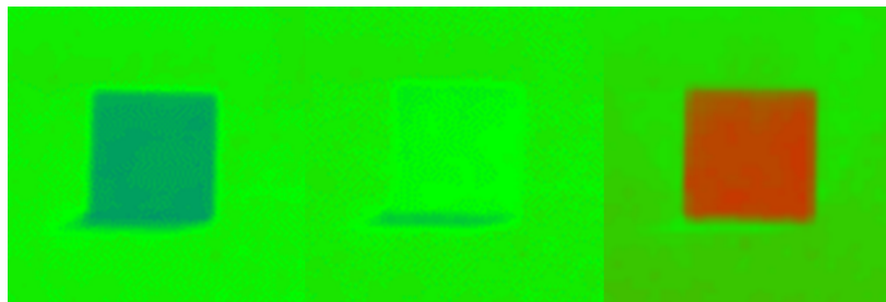
Abbildung 3.21.: Kontrastübergang durch das Zusammenspiel der ortsfesten Straßenbeleuchtung und der Kfz-Beleuchtung innerhalb geschlossener Ortschaften; die Straßenbeleuchtung erzeugt einen sichtbaren Negativkontrast zwischen Objekt und Umgebung (links), durch die Kfz-Beleuchtung findet ein Übergang vom Negativkontrast zum Positivkontrast statt (rechts); heben sich die Einflüsse der Straßenbeleuchtung und der Kfz-Beleuchtung gegenseitig auf, so ist kein Kontrast zwischen Objekt und Umgebung vorhanden und eine Objektdetektion nicht möglich (mitte).
