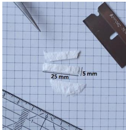
Abbildung 65: Probenpräparation der Papiere in 25 mm lange und 5 mm breite Streifen zur mechanischen Analyse mittels DMTA.
