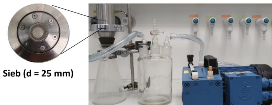
Abbildung 54: Verwendete Apparatur zu Herstellung einheitlicher Papiere mit Polymeradditiv bestehend aus einem Sieb ( d = 25 mm), Siebträger, Saugflasche, Woulffsche Flasche und Vakuumpumpe.
