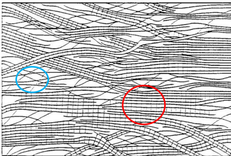
Abbildung 8: Fransenfibrillarmodell nach HAERLE et. al. Die kristallinen Domänen (exemplarisch rot markiert) sind von amorphen Bereichen (exemplarisch blau markiert) umgeben. Mit Genehmigung übernommen und bearbeitet aus Referenz [31] .
