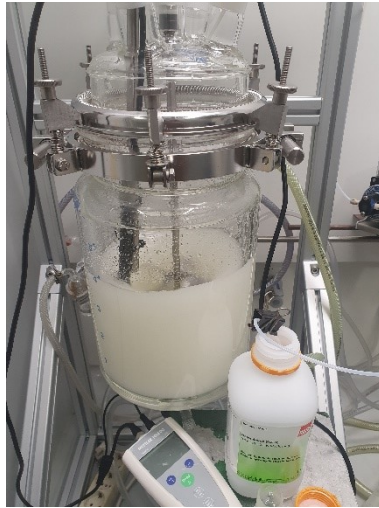
Abbildung 101: Beispielhafter Aufbau des 5 L Reaktors für die TEMPO-Oxidation von Baumwolllinters.
