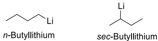
Abbildung 3: Strukturformel der gängigen Alkyl-Lithiumverbindungen zur Verwendung als Initiator bei einer anionischen Polymerisation. links: n -Butyllithium; rechts: sec -Butyllithium.
