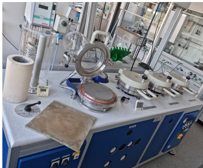
Abbildung 21: Laborblattbildungsgerät (RAPID-KÖTHEN BB3, AK Biesalski- TU Darmstadt) der Firma ESTANIT GmbH.
