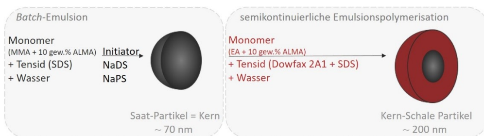
Schema 9: Reaktionsschema für die Herstellung von PMMA_PEA Kern-Schale Partikel im Standardverfahren mit Redoxinitiator und anionischen Tensiden.
