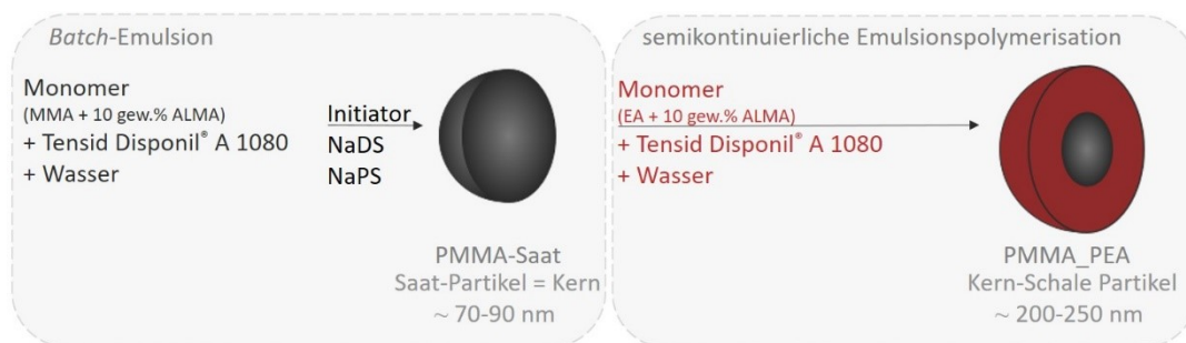
Schema 10: Reaktionsschema für die Herstellung von PMMA_PEA Kern-Schale Partikel mit Redoxinitiatorsystem und dem neutralen Tensid Disponil® A 1080.
