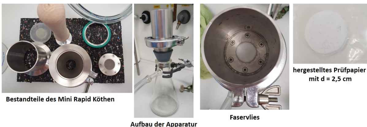
Abbildung 102: Bestandteile des konstruierten Mini-RAPID-KÖTHEN, sowie der Aufbau der Apparat, der resultierende Faservlies und das letztlich hergestellte Prüfpapier.
