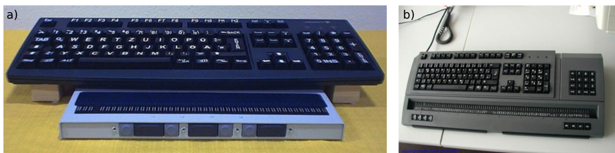
Abbildung 1: Beispiele für kommerzielle Braille-Zeilen: a) Braille-Zeile InfoDot 40 zur Verwendung mit herkömmlichen Tastaturen [9]; b) Tastatur mit integrierter Braille-Zeile [10]. Die Abbildungen sind den gekennzeichneten Quellen entnommen.
