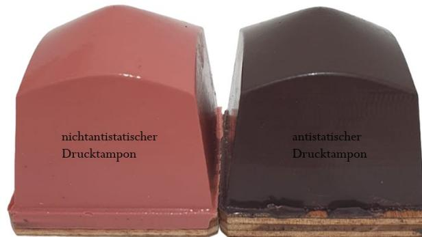
**Abbildung 6-17:** Ein quadratischer Drucktampon N81 aus 6 Shore RTV2-Silikonkautschuk ohne SWCNT (nicht antistatisch, links) und mit SWCNT (antistatisch, rechts).
