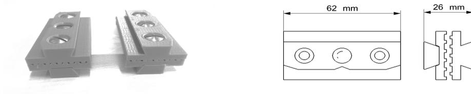
Abbildung 4-12: Additiv gefertigte verzahnte PLA-Spannbacken für einachsige und planare Zugversuche. Auf der rechten Seite sind die wichtigsten Hauptmaße der Spannbacken dargestellt. Zahnhöhe ist 2 mm.
