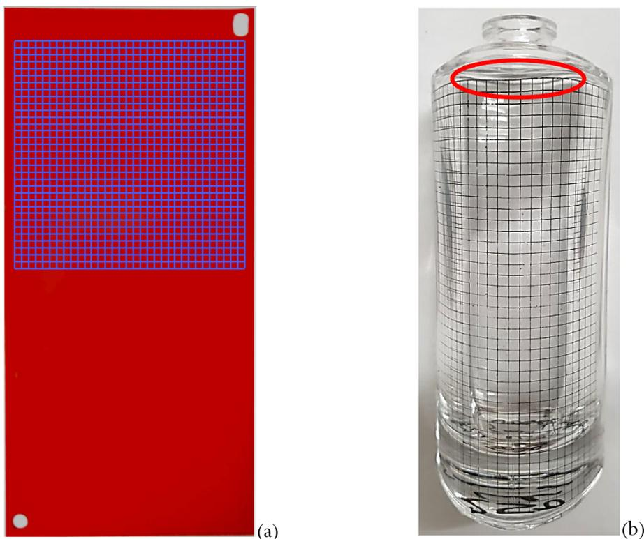
**Abbildung 6-5:** Links ist eine digitale Abbildung des Klischees mit dem quadratischen Raster (a). Rechts ist ein Foto des bedruckten Flakons (b). Die rote ovale Markierung zeigt eine Verzerrung der gedruckten Rasterlinien am Rand des Flakons, wo die gebogenen Gitternetzlinien des Drucktampons in Abbildung 6-2a sind.
