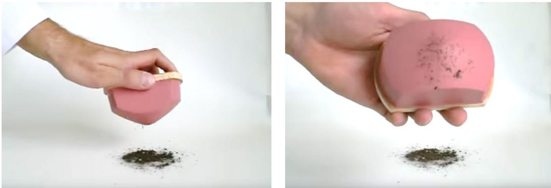
**Abbildung 2-6: Schnelltest zur Erfassung der statischen Aufladung eines Drucktampons (Lück, 1999).**
