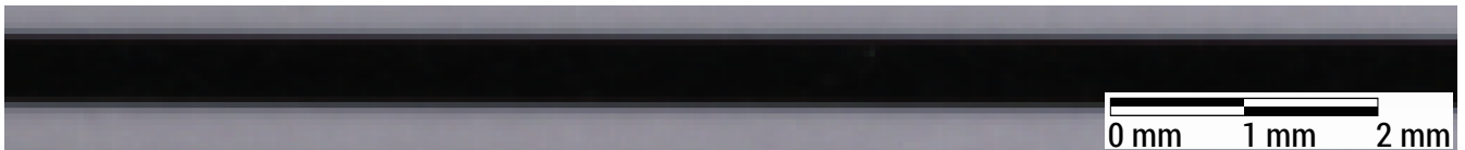
Abbildung 4.3.: Leicht geneigter schwarzer Balken der Kalibrierseite aus Abbildung 3.5 zur Bestimmung der Punktstreiffunktion.
