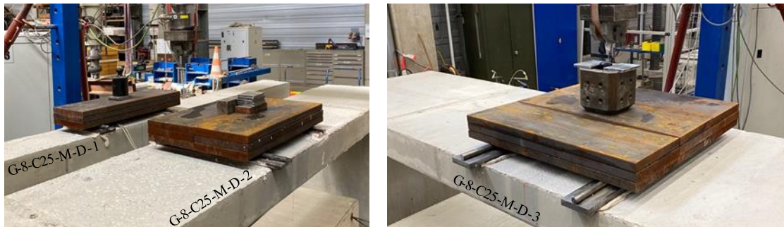
Abbildung 4-15 Exemplarische Belastungssituation der Bauteilversuche unter Dauerlast
