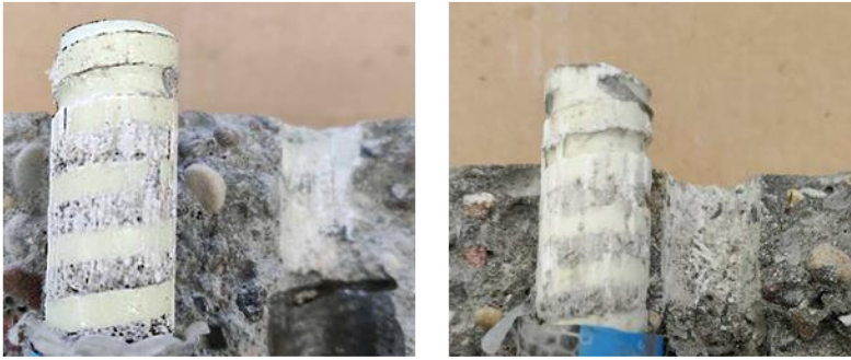
Abbildung 4-7 Beispielhafte Versagensmodi an den gespaltenen Versuchskörpern S1-G16-3 (links) und S2-G16-3 (rechts)
