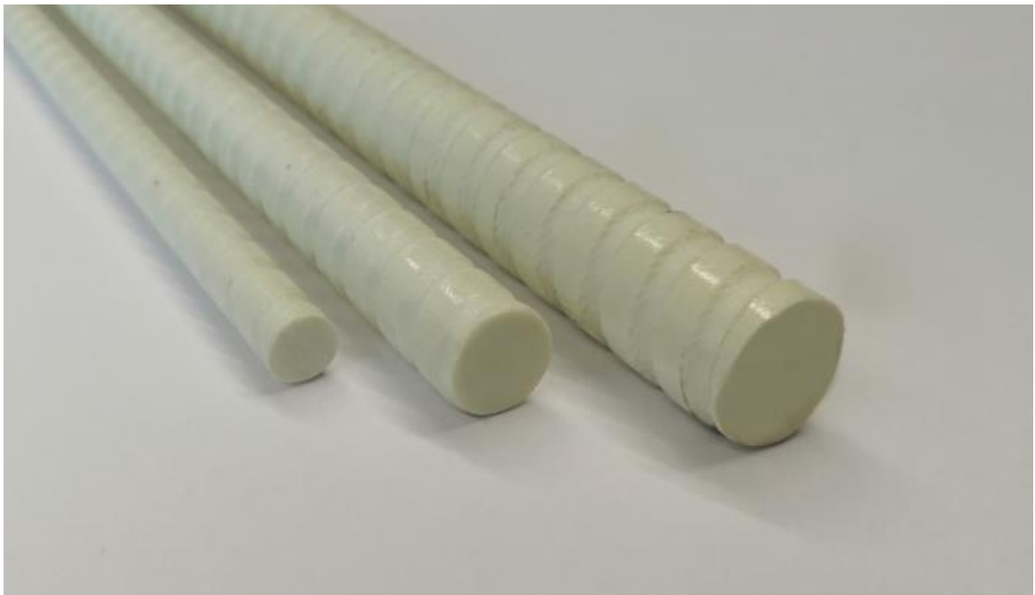
Abbildung C - 1 Oberflächenstruktur der eingesetzten GFVK-Bewehrung
