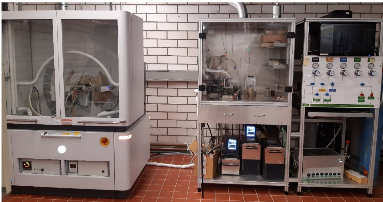
Abbildung 7: Anlage für die Durchführung von in situ -Messungen. Links: Diffraktometer, Mitte: Abzug mit Sättigern, Rechts: Gassteuerung.
