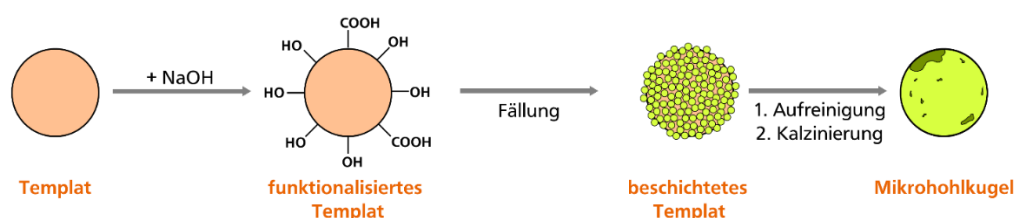
Abbildung 2: Schematische Darstellung der Vorgehensweise zur Synthese von Mikrohohlkugeln. [45]
