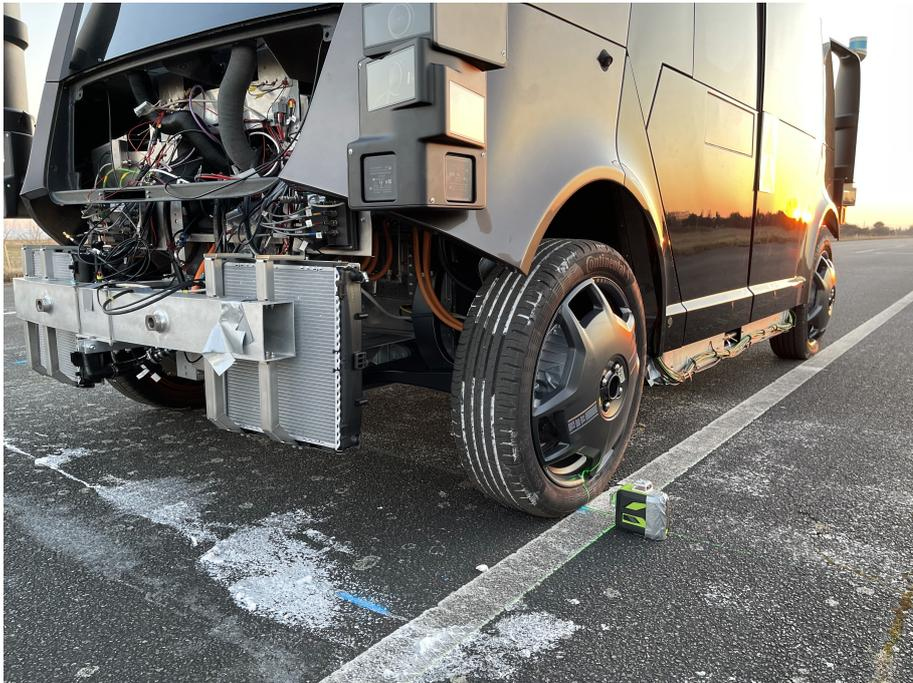
Abbildung 8-7: Positionierung des Fahrzeugs relativ zu den bekannten, GCS-referenzierten Messpunkten unter Zuhilfenahme eines Kreuzlinienlasers. Die Außenkante des dargestellten Reifens stimmt mit der Position des bekannten Messpunkts überein.
