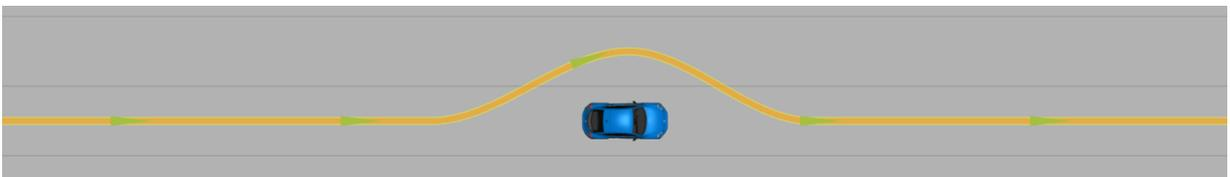
Abbildung 8-25: Doppelter Fahrstreifenwechsel als Testszenario für die Robustheit ggü. Latenzen der Planungsebene. Der Gierwinkel des Fahrzeugs wird so gewählt, dass während des gesamten Manövers  $\psi_{\text{set}} = \psi_{c,\text{set}}$  gilt.
