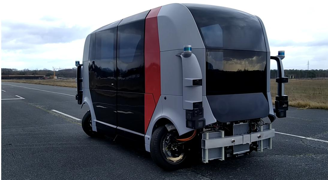
Abbildung 2-10: Seitliches Einparken des UNICARagil-Fahrzeugs autoSHUTTLE mit 90° Radlenkwinkel an allen Rädern durch Verwendung der unabhängigen Dynamikmodule<sup>85</sup>.
