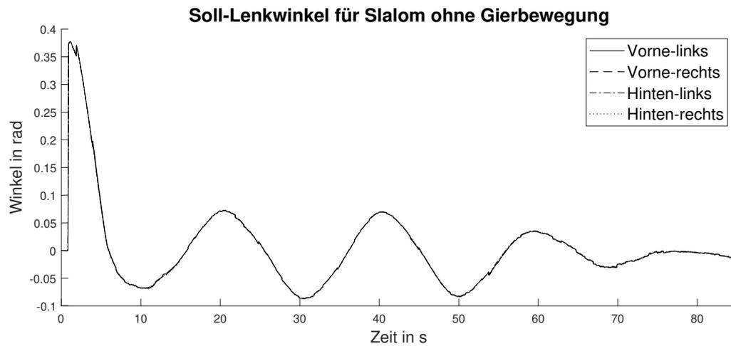
Abbildung 8-31: Von der FTR berechnete Soll-Lenkwinkel für den Slalom ohne Gieraktivität des Fahrzeugs.
