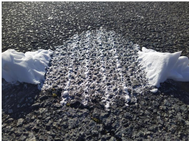
Abbildung 8-6: Hinterlassene Spurmarkierung im Rasierschaum nach Fahrt durch den Versuchsaufbau.
