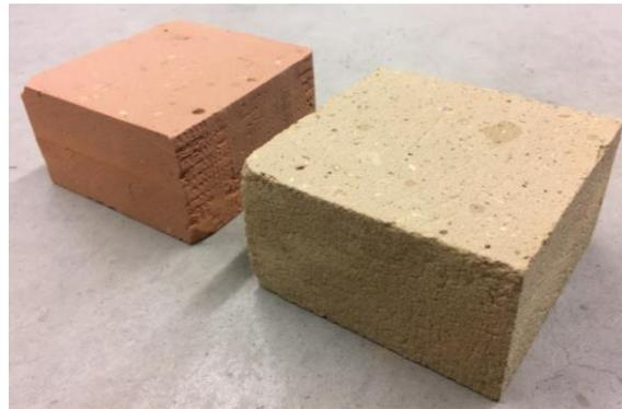
Abbildung 4-1: Probekörper des Lehmsteins I (rechts) und des Lehmsteins II (links)
