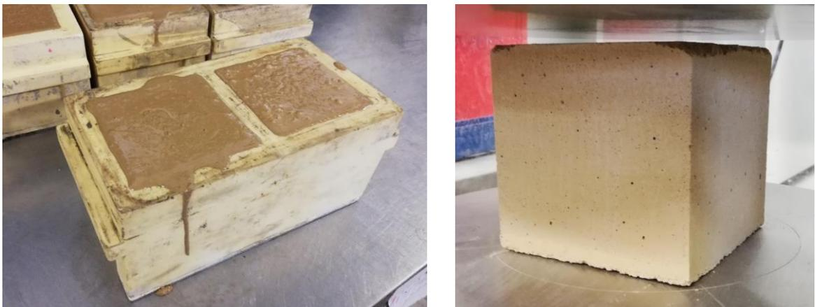
Abbildung 4-8: Frischmörtel in der Würfelschalung (links) und Probekörper vor der Prüfung (rechts)
