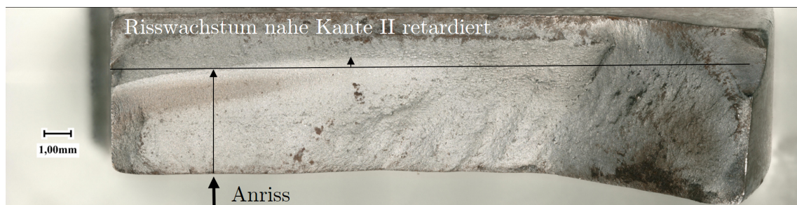
Abbildung 6.13: Bruchfläche einer von einem Defekt zwischen Kante II und Kante III gebrochenen Feder. Die vertikale Ausdehnung der Bruchfläche ist direkt am Rissausgangsort kleiner als rechts davon.
