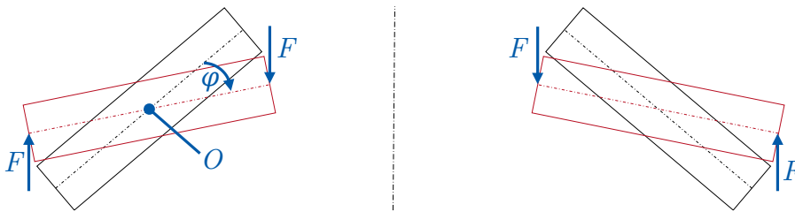
Abbildung 2.2: Querschnitt vor (schwarz) und nach (rot) Drehung um \varphi um den Stülpmittelpunkt O infolge der Federkräfte F (Anstellwinkel der unverformten Feder zur Verdeutlichung vergrößert dargestellt).
