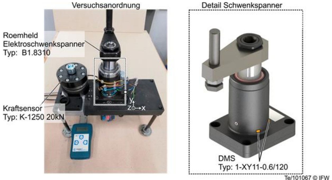
Abbildung 15: Versuchsanordnung zur experimentellen Ermittlung der auftretenden Dehnungen
