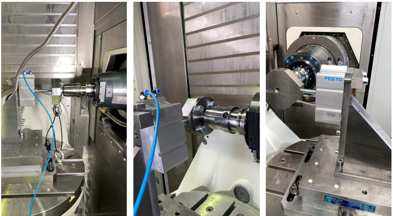
Abbildung 26: Kalibriervorrichtung für spike_inspindle
