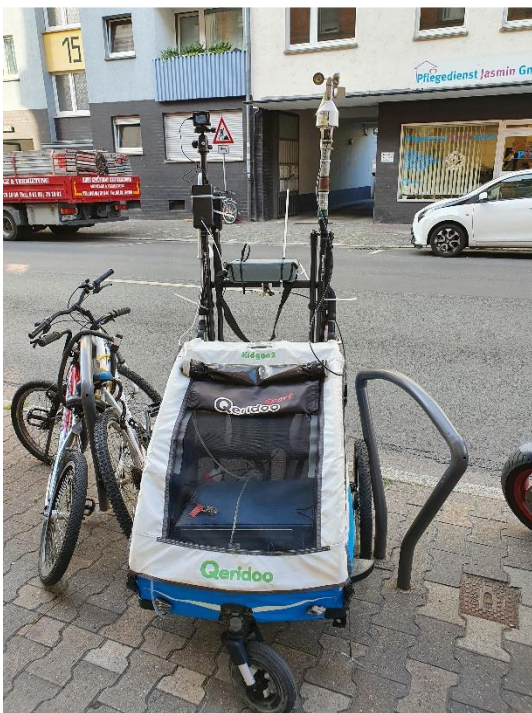
Abbildung 36: Aufbau der Messgeräte während stationärer Messungen Quelle: Eigene Aufnahmen
