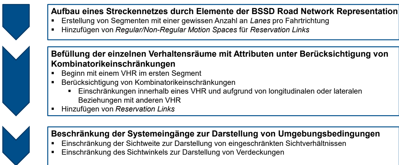
Abbildung 4-17: Methodik zur Generierung einer funktionalen Szenerie
