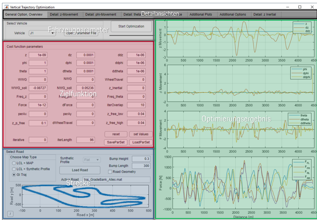
Abbildung 6.3.: Übersichtsseite des Graphical User Interface (GUI) für die Vertikaltrajektorienplanung
