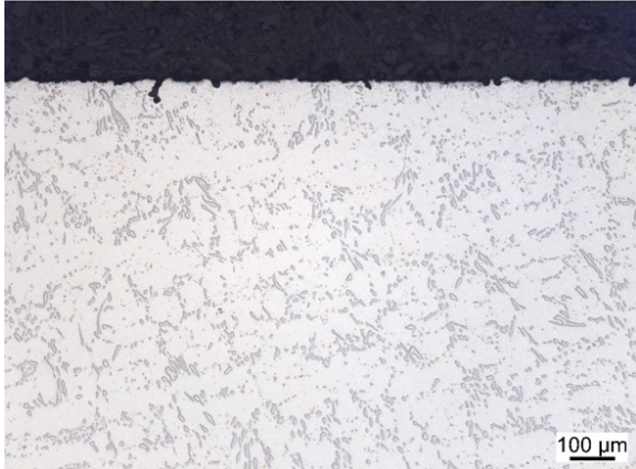
Abbildung 6-14: Lichtmikroskopische Aufnahmen von Schliffen an Proben des Werkstoffs Centralloy 60 HT R im ungeätzten Zustand, \sigma=2 MPa, a) Probe cMS11z6: isotherm 1100 °C, Laufzeit 1538 h, b) Probe cMS11z7: T_{\max}=1100 °C, \Delta T=200 K, \dot{T}=6,67 K/min, t_{\text{Halte}}=1,5 h, t_{\text{Rampe}}=0,5 h, Laufzeit 2542 h
