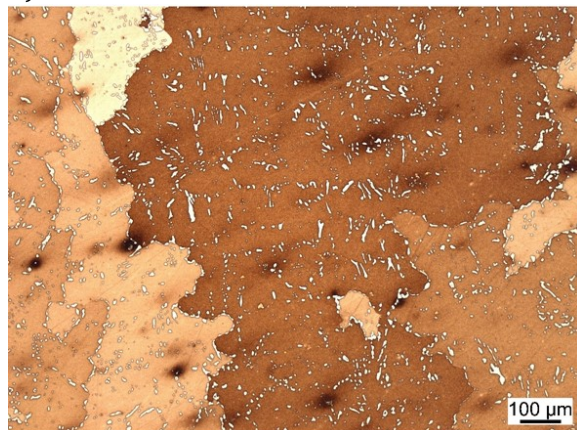
Abbildung 6-3: Lichtmikroskopische Aufnahmen von Schliffen an Proben des Werkstoffs Centralloy 60 HT R, \sigma=2 MPa, Probe cMS11z6: isotherm 1100 °C, Laufzeit 1538 h, a) ungeätzt und b) mit V2A-Beize geätzt; Probe cMS11z7: T_{\max}=1100 °C, \Delta T=200 K, \dot{T}=6,67 K/min, t_{\text{Halte}}=1,5 h, t_{\text{Rampe}}=0,5 h, Laufzeit 2542 h, c) ungeätzt und d) mit V2A-Beize geätzt
