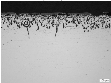
Abbildung 6-15: Lichtmikroskopische Aufnahmen der Probenoberfläche von Schliffen an Proben des Werkstoffs 1.4841 im ungeätzten Zustand, \sigma=2 MPa, a) Probe eLC11z2: isotherm 1100 °C, Laufzeit 1867 h, b) Probe eLC11za3: T_{\max}=1100 °C, \Delta T=200 K, \dot{T}=6,67 K/min, t_{\text{Halte}}=1,5 h, t_{\text{Rampe}}=0,5 h, Laufzeit: 1028 h, c) Probe eLC11za5: T_{\max}=1100 °C, \Delta T=200 K, \dot{T}=6,67 K/min, t_{\text{Halte}}=1,5 h, t_{\text{Rampe}}=0,5 h, Laufzeit: 8595 h
