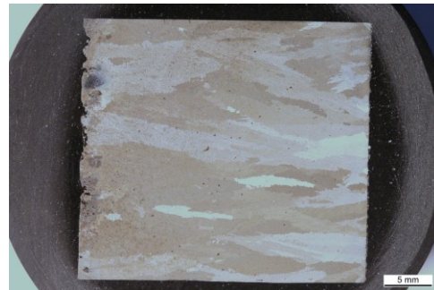
Abbildung 4-5: Lichtmikroskopische Aufnahme des Längsschliffs des entnommenen Gussrohlings; Ätzung: V2A-Beize
