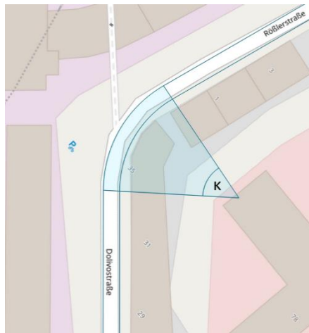
Abbildung 5-2: Geometrische Winkelnäherung der Kurve in Streckenabschnitt 7
