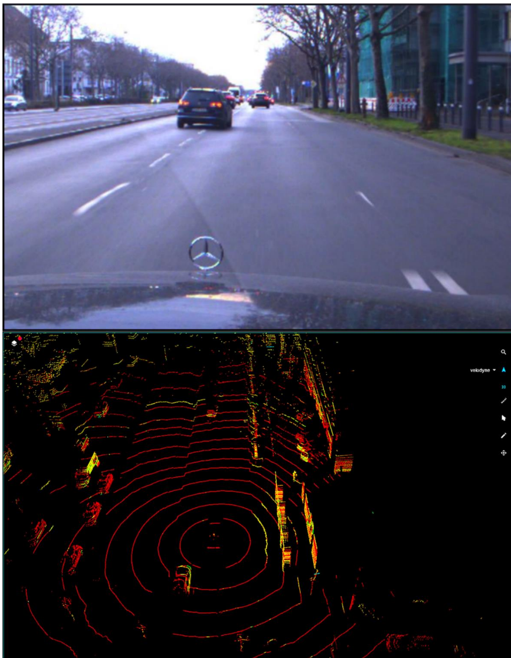
Abbildung 4-10: Ausschnitte aus dem Kamerabild (oben) und der Punktwolke des Velodyne VLP-32 C (unten) während einer Stadtfahrt
