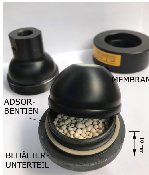
Abbildung 5.2 – Füllung des Hydrospeichers mit Adsorbentien. Im Hintergrund sind links das Speicheroberteil und rechts die Mutter zu sehen.
