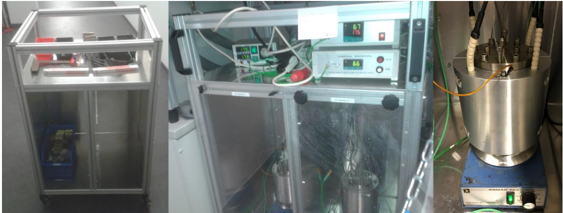
Abbildung 4-4: Fahrbare Autoklavensicherheitszelle im Aufbau (links), Betrieb von zwei HT-Reaktoren gleichzeitig (mit erster Barriere, zweite Barriere für Fotoaufnahme abgenommen; mitte) und eingebauter HT-Reaktor mit beheizbaren Halbschalen (rechts).
