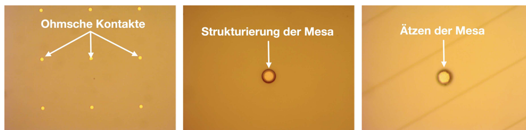
Abbildung 4.8: Fotos nach den Hauptprozessschritten der Gunn-Dioden. Der Diodendurchmesser beträgt etwa 21 \mu\text{m} . a) Ohmsche Kontakte, b) Strukturierung der Mesa und c) Ätzen der Mesa.
