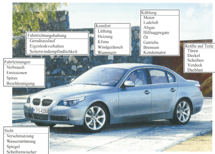
Bild 1.1 Aerodynamische Faktoren. Wiederverwendung von Hucho (2005) mit Genehmigung der Springer Nature Customer Service Center GmbH. © Springer Fachmedien Wiesbaden 2005.
