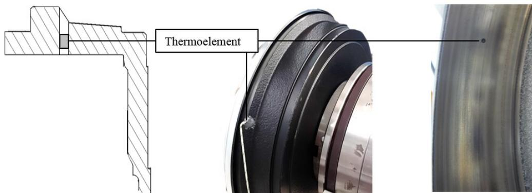
Abbildung 5-5: Trommel mit Temperatursensor
