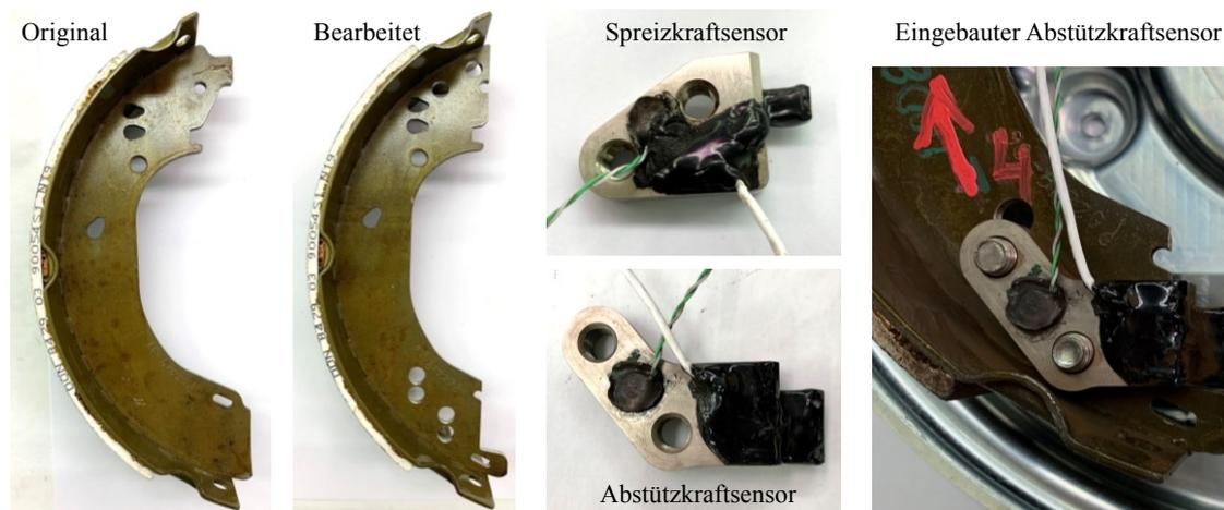
Abbildung 5-3: Bremsbacke, Abstützkraft- und Spreizkraftsensor
