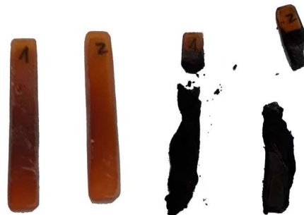
Abbildung 61 UL94-Probe von D.E.N. 438 vor (links) und nach (rechts) dem UL94-Vertikalbrandtest. Die Fotos wurden von Adrian Baumunk aufgenommen und sind in abgewandelter Form in seiner Bachelorarbeit 224 veröffentlicht.
