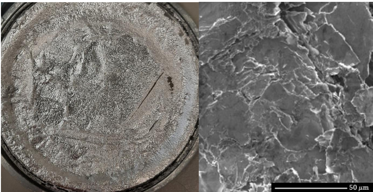
Abbildung 13: Photographische Aufnahme (links) einer Paste mit durch physikalische Gasphasenabscheidung erhaltenen Aluminiumpigmenten der Marke Decomet® von Schlenk Metallic Pigments GmbH sowie REM-Aufnahme (rechts) der Pigmente nach Trocknung, welche hervorgerufen durch ihr hohes Aspektverhältnis intensive Agglomeration nach Trocknung zeigen.
