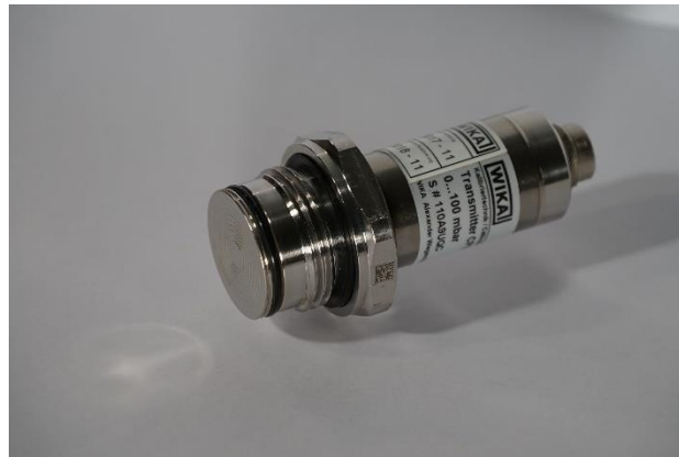
Abb. B-2: Im Versuch verwendeter piezoresistiver Druckmessgeber
