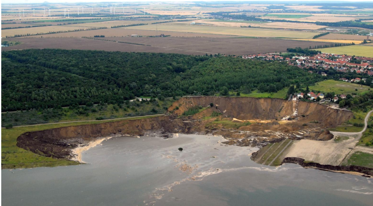
Abb. 1-1: Rutschungskessel im Tagebau NACHTERSTEDT 2009 (Foto: PICTURE-ALLIANCE/ DPA)
