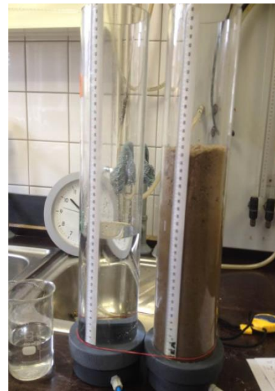
Abb. 2-28: Säulenversuch nach ZANDER (2015)
