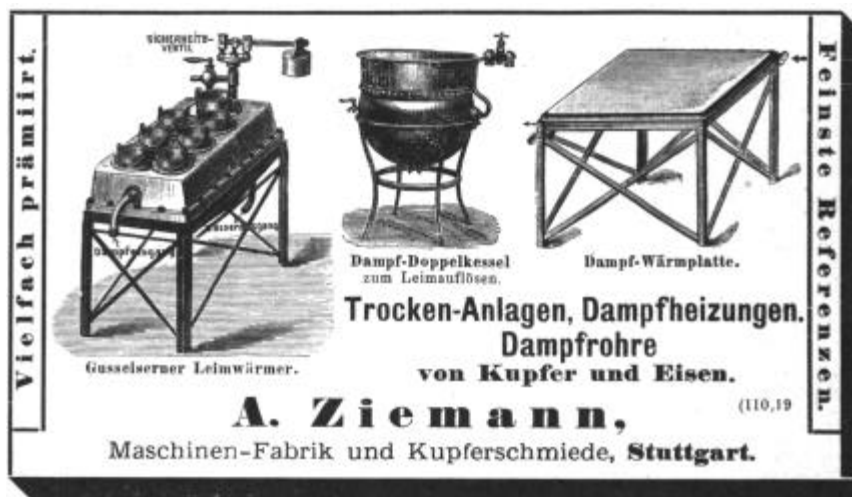
Abbildung 73: Werbung für Leimwärmer, Leimkocher und Wärmeplatten für den Dampftrieb; Deutsche Tischler-Zeitung 1889. Die Wärmeplatten dienten dazu, das zu verleimende Holz vor dem Verleimen anzuwärmen, um ein zu rasches Auskühlen des Heißleimes und damit Fehlverleimungen zu vermeiden.
