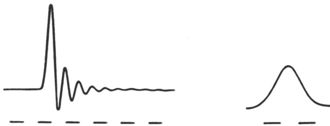
Bild 2a Schwingungsverhalten des Druckaufnehmers nach erfolgter Stoßbeanspruchung. Eingezeichneter Zeitmaßstab: Strichlänge = 10^{-8} s
