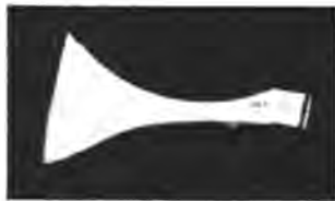
Abb. 27. Führungsrolle für Hefstössel springt von der Steuerkurve ab bei etwa 20 000 U/h (Schattenbild)
