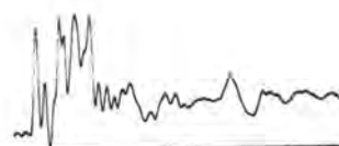
Abb. 8. Beispiel eines Zugkraft- diagrammes in der Versuchs- maschine (die hohen Amplitu- den links sind vom Brems- werk verursacht)
