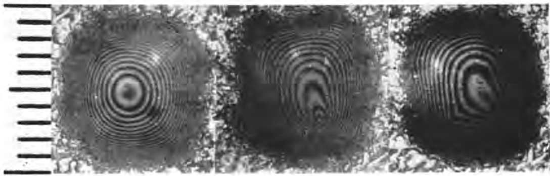
Abb. 20. Farbvolumen 1,6 \cdot 10^{-5} \text{ mm}^3 2000 U/min 1,1 \cdot 10^{-5} \text{ mm}^3 4000 U/min 1,0 \cdot 10^{-5} \text{ mm}^3 6000 U/min
