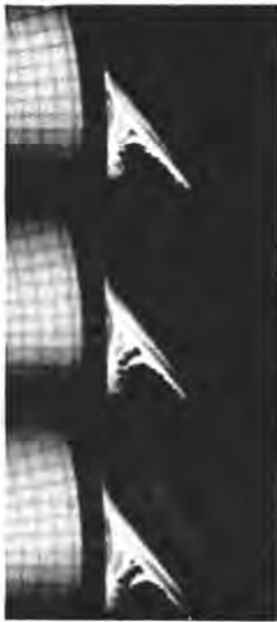
Abb. 1. Rupfvorgang im Papier (IGT-Prüfgerät), 3 Phasen – 2800 Bilder/sec
