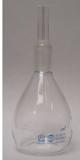
Abbildung 2.7.: Pyknometer ( V=50 \text{ cm}^3 ) zur Bestimmung der Dichte pulverförmiger Materialien.
