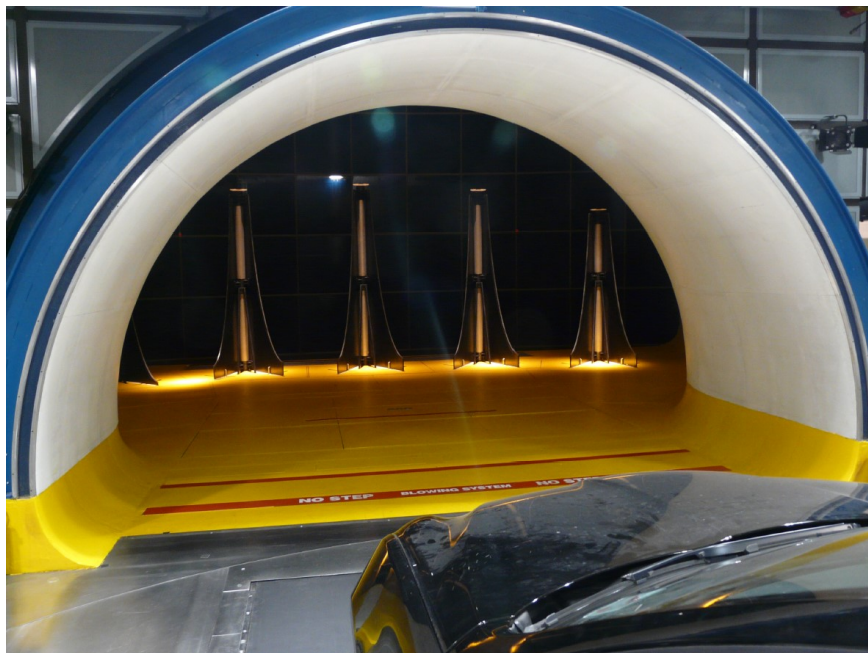
Abbildung 3.10: Turbulenzgeneratoren in der Düse des Pininfarina-Windkanals. [102]
