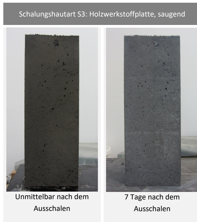
Abbildung 4-14: Entwicklung der Sichtbetonfläche geschalt mit der Schalungshautart S3 286
