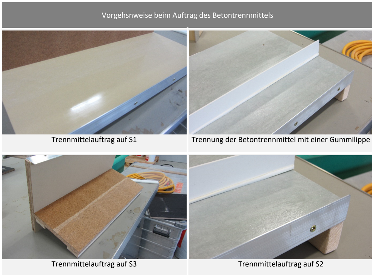
Abbildung 4-4: Vorgehensweise beim Auftrag des Betontrennmittels 270
