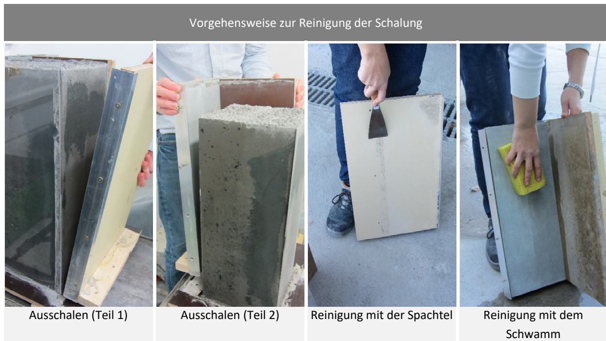
Abbildung 4-6: Vorgehensweise zur Reinigung der Schalung 275
