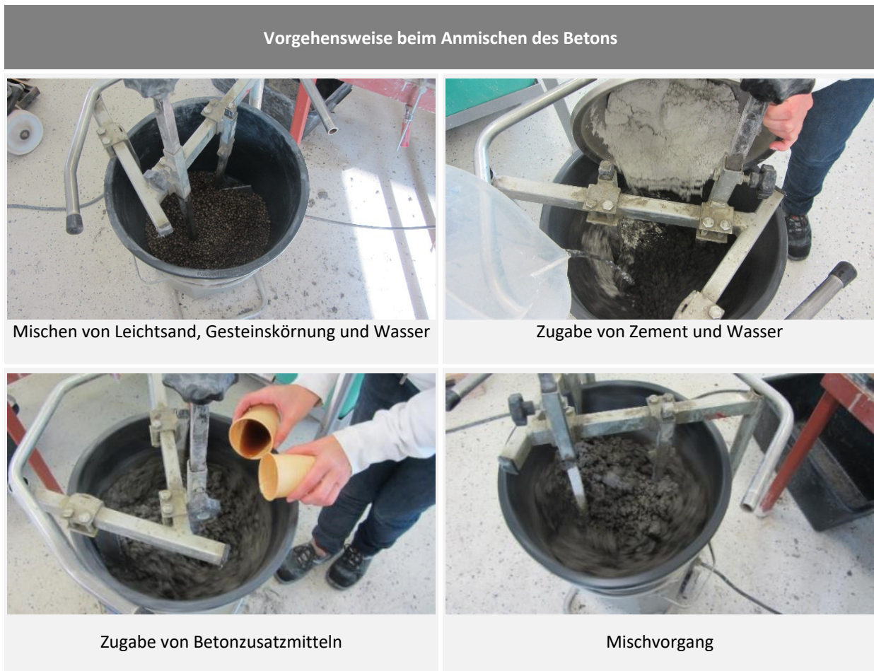
Abbildung 4-5: Vorgehensweise beim Anmischen des Betons 271
