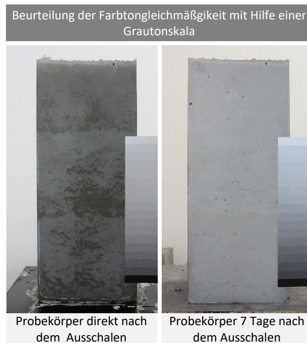
Abbildung 4-12: Beurteilung der Farbtongleichmäßigkeit mit Hilfe einer Grautonskala 282
