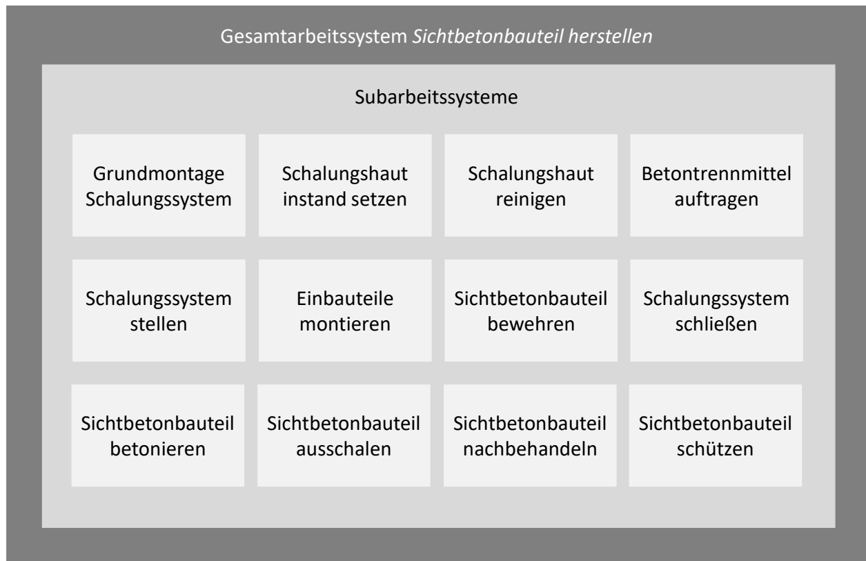
Abbildung 1-6: Untergliederung des Gesamtarbeitssystems Sichtbetonbauteil herstellen in Subarbeitssysteme 36
