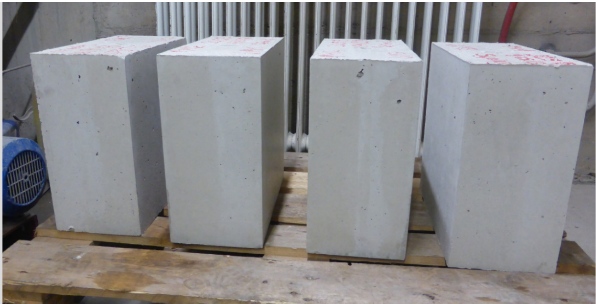
Abbildung 4-51: Probekörper nach dem dritten Einsatz der Schalungshäute 397
