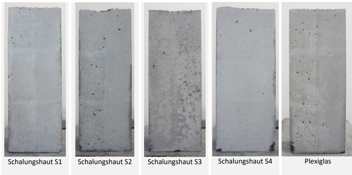
Abbildung 4-9: Einfluss der Schalungshautart und des Betontrennmittels auf die Sichtbetonflächen der Leichtbetonprobekörper 278
