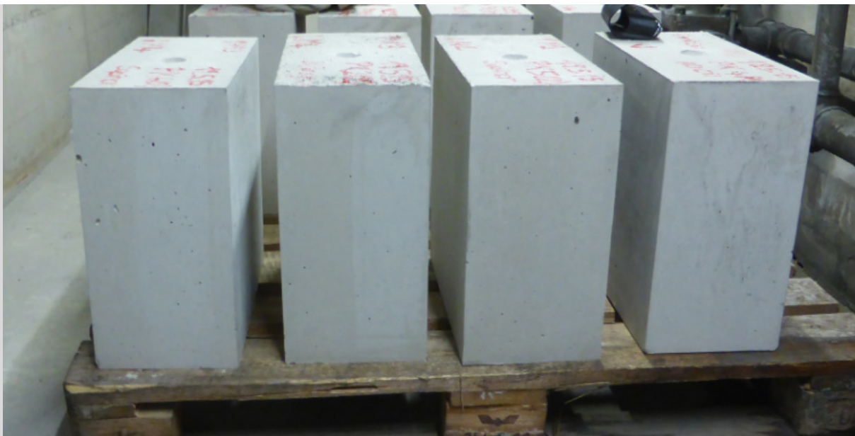
Abbildung 4-50: Probekörper nach dem zweiten Einsatz der Schalungshäute 396
