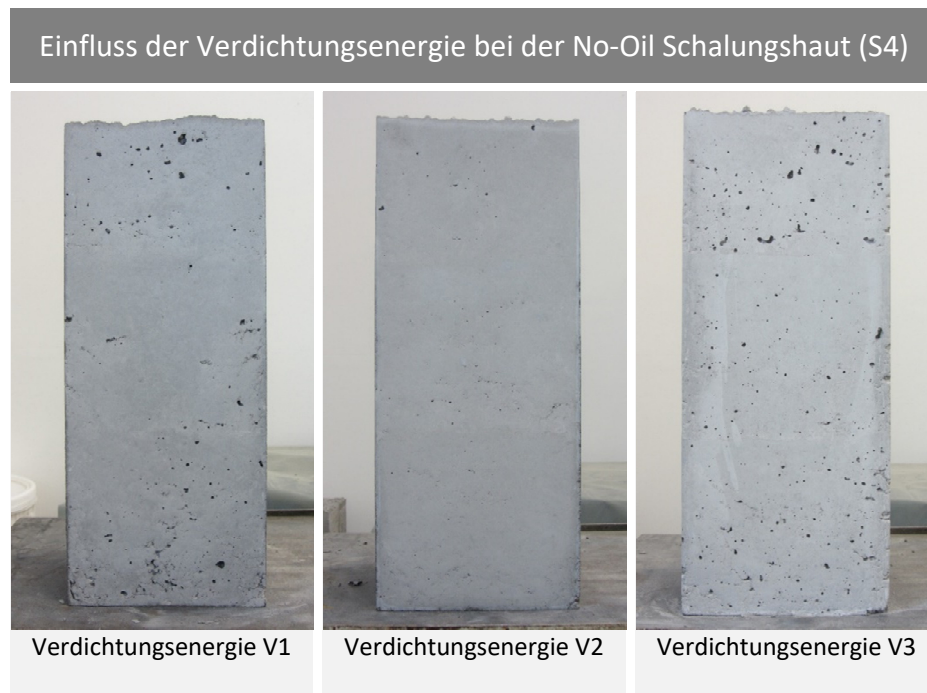
Abbildung 4-10: Einfluss der Verdichtungsenergie bei der No-Oil Schalungshaut (S4) 279
