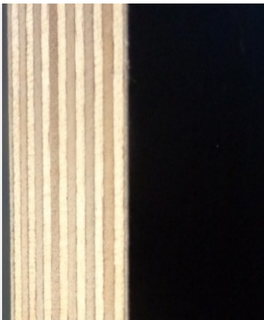
Abbildung 4-18: Birkensperrholzplatte mit Phenolharzbeschichtung
