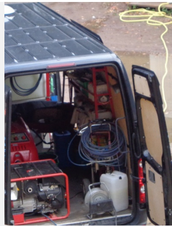
Abbildung 4-58: Mechanisches Reinigen (nass) von Sichtbetonbauteilen, Arbeitskraft und Betriebsmittel
