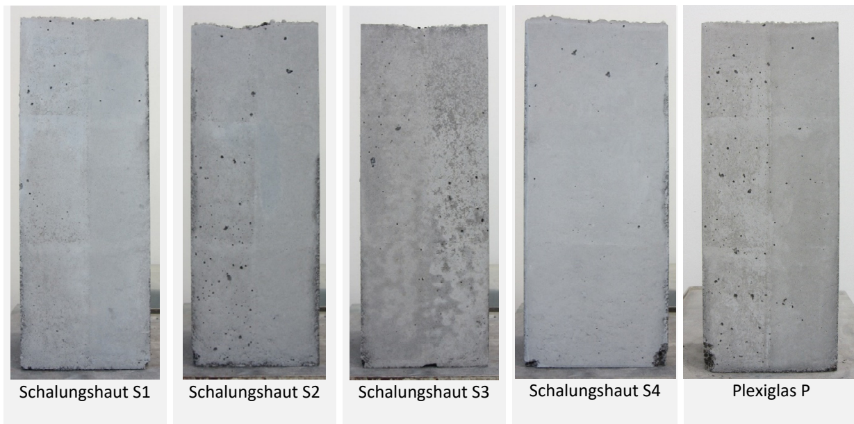
Abbildung 4-15: Einfluss der Schalungshautart und des Betontrennmittels auf die Sichtbetonflächen der Leichtbetonprobekörper 287
