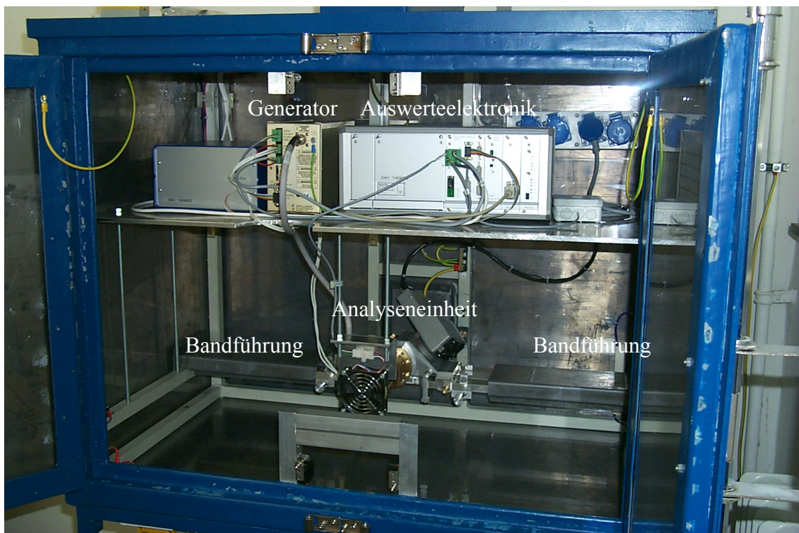
Abb. 42: Innenansicht der Analysenapparatur.
